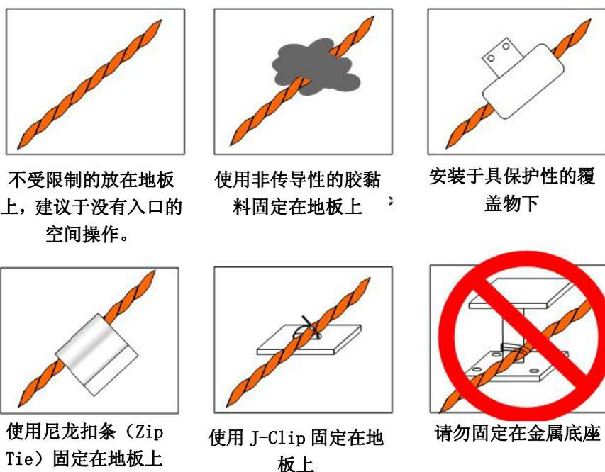
图 2.5 电缆安装方法
